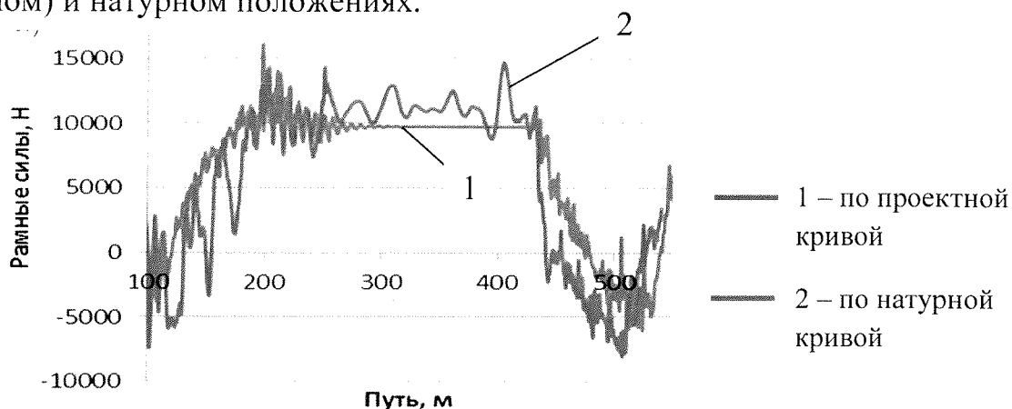
Рисунок 6 – Результаты расчета рамных сил со скоростью движения 60 км/ч.
